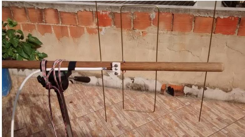
**Figura 20:** Antena posicionada para captar o sinal da radiossonda. A antena foi fixada em um tripé de câmera fotográfica.
