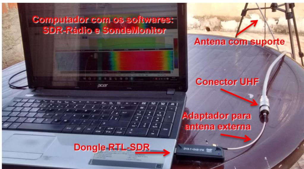
**Figura 21:** Equipamento conectado para captar o sinal da radiossonda.
