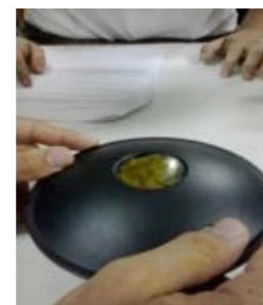
Figura 2. Um “sapinho” de plástico está localizado no interior dos espelhos côncavos. Sua imagem é formada na região exterior dos espelhos combinados, acima do orifício de um dos espelhos empregado.
