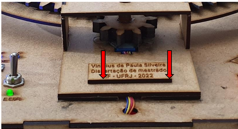
Figura 50: Peças 48 e 49 coladas sobre a base de MDF próximas do furo circular por onde passa o fio do motor de passo.
