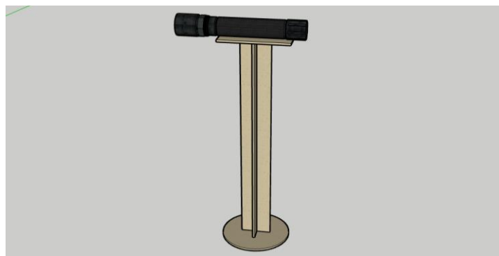
Figura 46: Peças 43, 44, 45, 46 e 47 após serem coladas para montar o suporte da lanterna.
