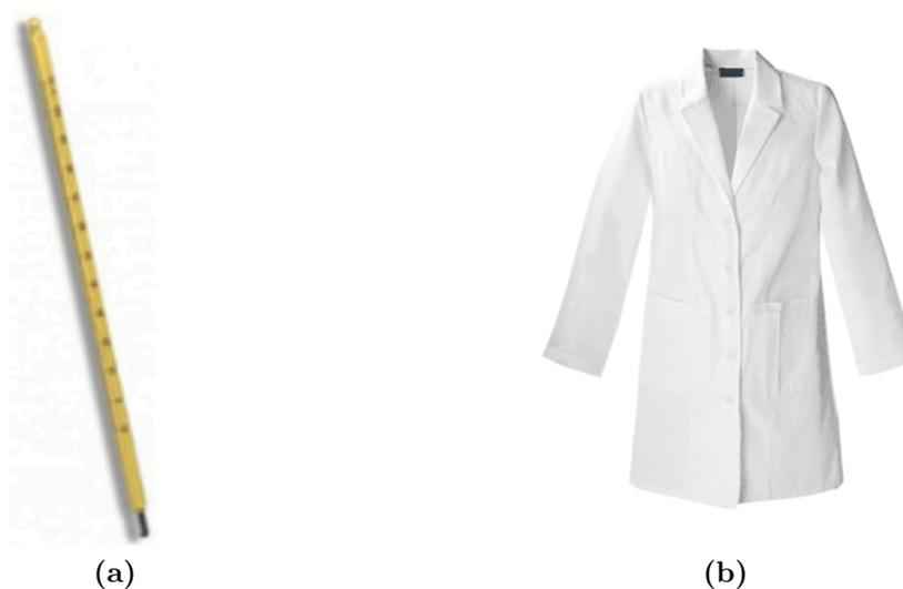
**Figura 2.** – (a) Termômetro químico de mercúrio apropriado para medir temperaturas de líquidos com escala externa de  $-10,0\text{ }^{\circ}\text{C}$  à  $150,0\text{ }^{\circ}\text{C}$  e uma incerteza de  $\pm 0,5\text{ }^{\circ}\text{C}$ . (b) Recomendamos o uso de jalecos de proteção durante a realização do experimento.
