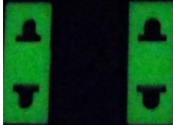
Figura 14: Fosforescência em tomadas antigas.
