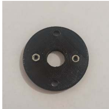
Figura 5.12: Tampa para rolamento linear impressa.
