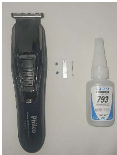
Figura 3.48: Material necessário para montar o experimento Pêndulo de Kapitza de baixo custo.
