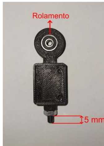
Figura 5.17: Montagem do rolamento 623-2RS e do parafuso de fixação na base do pivô.
