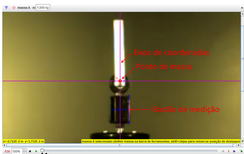
Figura 4.2: Eixos de coordenadas, “Ponto de Massa A” e “Bastão de Medição” no quadro inicial.
