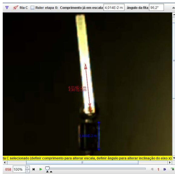
Figura 4.19: Fitas métricas usadas para marcar o centro de massa e medir a distância do centro do pivô ao centro de massa.
