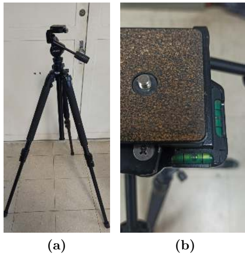
Figura 3.57: (a) Tripé Slik Pro 780DX. (b) Nível de bolha do tripé Slik Pro 780DX.
