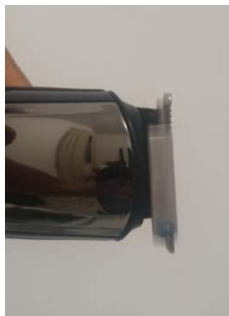
Figura 3.50: Máquina ligada e a barra na posição invertida em equilíbrio estável.
