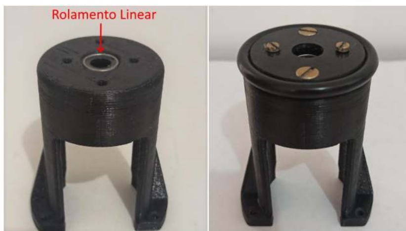
Figura 3.25: Montagem do rolamento linear, tampa para rolamento linear e do anel o'ring (anel de borracha) na carcaça porta rolamento.
