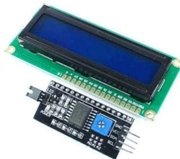
Figura 3.17: Display LCD 16 \times 2 e o módulo I2C. Fonte: [41]
