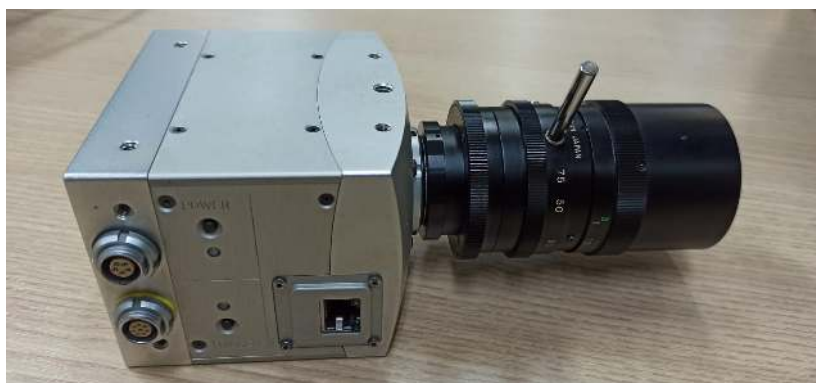
Figura 3.55: Câmera HiSpec 2 4G color com a lente Navitar TV Zoom Lens 12.5 - 75 mm F 1.8.
