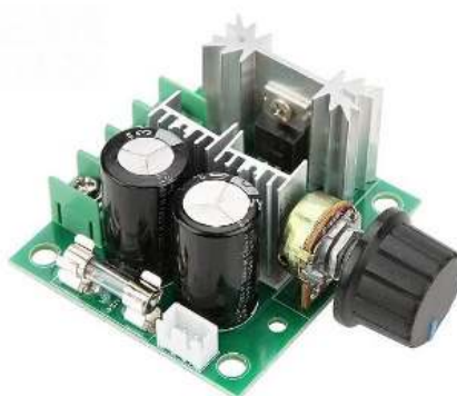
Figura 3.19: Controlador PWM 12 a 40 V DC, 10 A. Fonte: [44].
