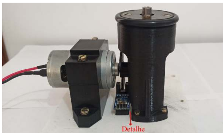
Figura 3.27: Montagem da carcaça porta rolamento na base geral. O detalhe na carcaça porta rolamento é um corte que foi feito na peça que demarca o lado que ela tem que ser montada. Não é possível montá-la utilizando o outro lado, pois a carcaça bateria no sensor.
