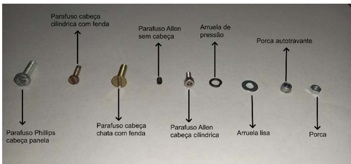
Figura 3.5: Tipos de porcas, parafusos e arruelas usadas na montagem da bancada experimental.
