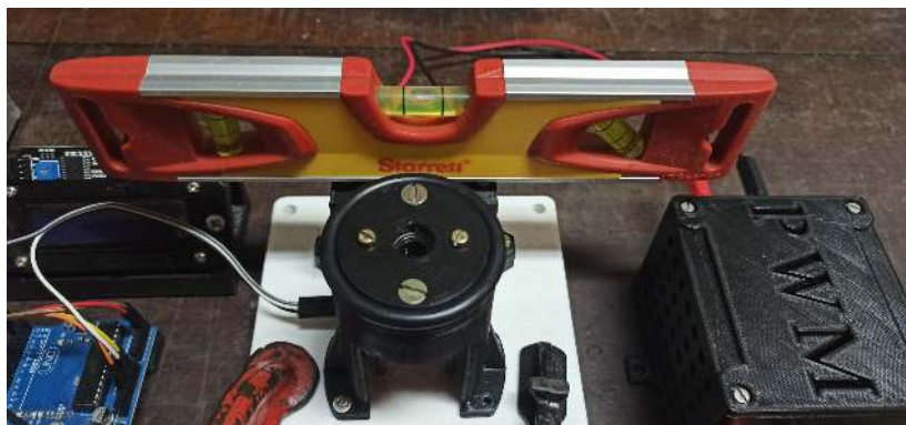
Figura 3.54: Nivelamento da bancada experimental com o nível de bolha.
