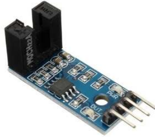
Figura 3.15: Sensor de velocidade encoder . Fonte: [39]
