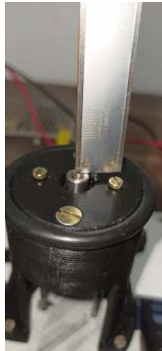
Figura 4.23: Medição realizada com o paquímetro para obter a amplitude de oscilação do pivô.
