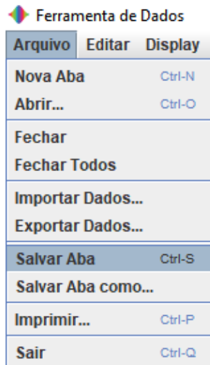
Figura 3.17: Forma de acessar a opção que permite salvar o ajuste da curva através da barra de menu da janela Ferramenta de dados.
