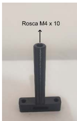
Figura 3.11: Garfo escocês impresso em 3D.
