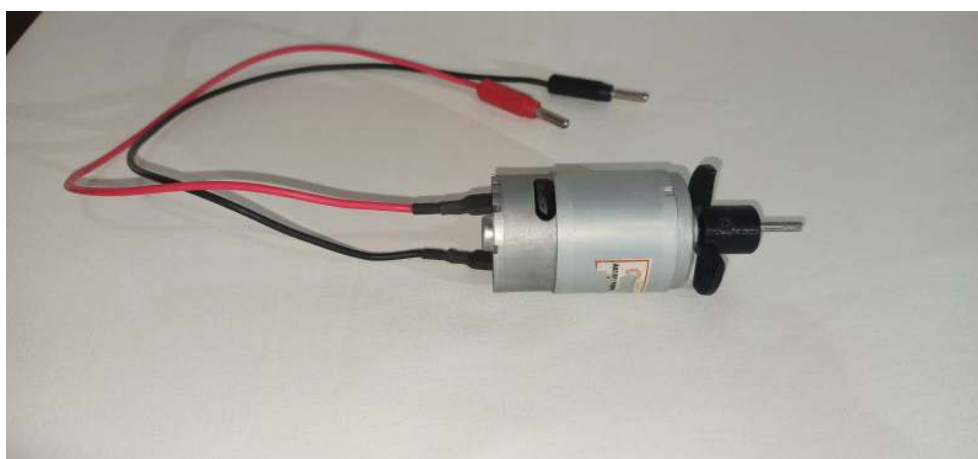
Figura 3.22: Motor com cabo soldado e acoplamento com excentricidade de 3 mm montado.
