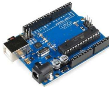
Figura 3.16: Placa Arduino UNO. Fonte: [40].
