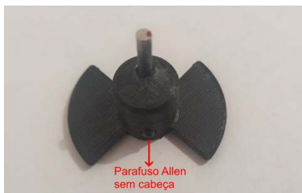
Figura 3.21: Acoplamento com excentricidade de 3 mm impresso.
