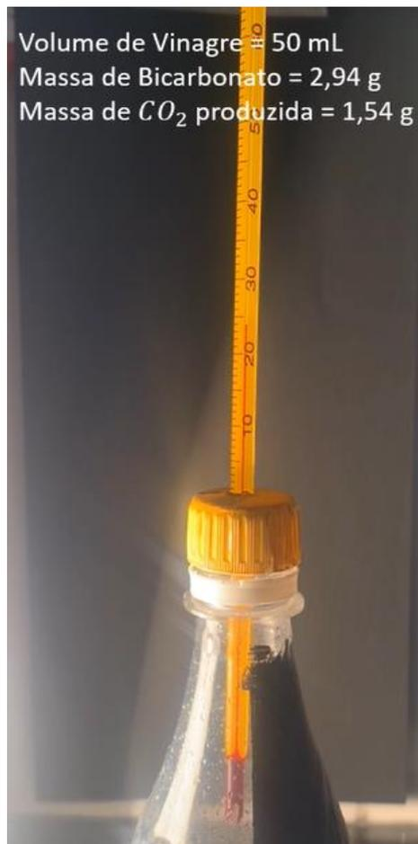
**Figura 3.3.** Imagem do vídeo produzido e disponibilizado para os estudantes. Além da filmagem da variação do termômetro, foram disponibilizadas as informações sobre os reagentes utilizados e a massa de  $CO_2$  produzida.
