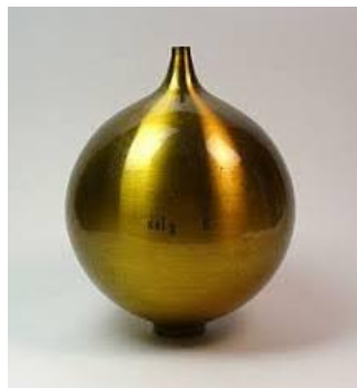
Figura 11: Ressonador de Helmholtz. Disponível em: http://physicsvirtualmuseum.ufop.br/acoustics/ressonadores-de-Helmholtz.html . Acesso em: 05/10/2022.
