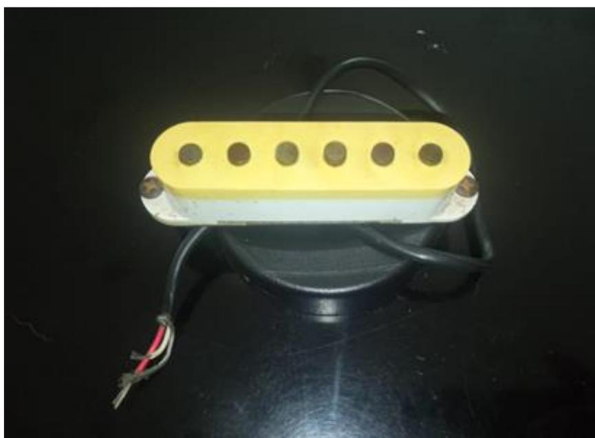
**Figura 11.** Captador de guitarra *single coil*
