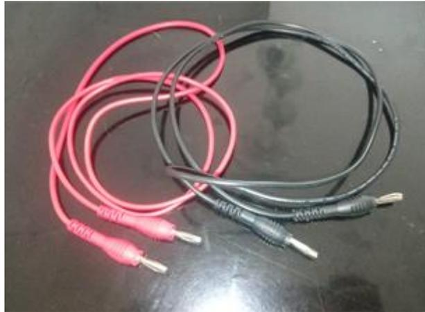
**Figura 15.** Pontas de prova com pino banana
