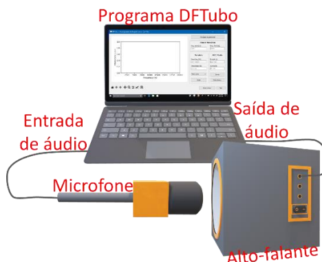
Figura 1 Disposição dos equipamentos nas atividades 1 e 2.
