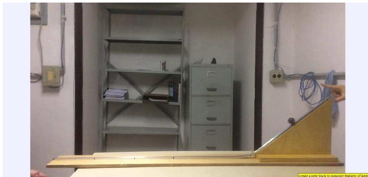
Figura 4.2: O “velocímetro galileano”. O aparelho reproduz a figura 3.5, presente no fólho de Galileu.
