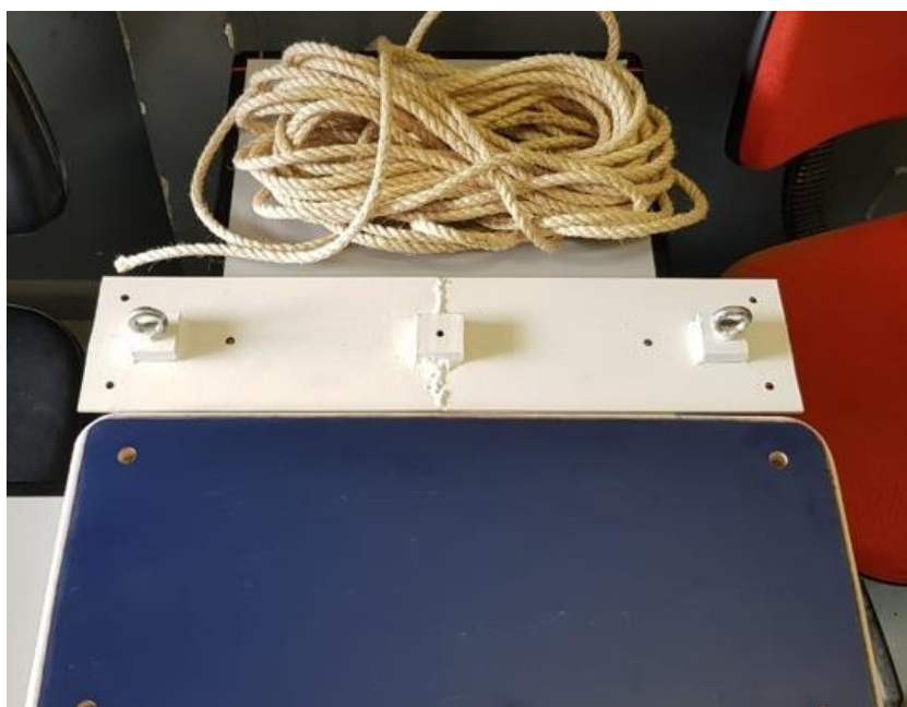
Figura 2.1: Balanço desmontado: assento em azul, plataforma que foi chumbada ao teto e cordas Fonte: Autoria própria
