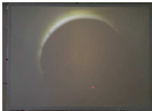
Figura 12. Agora com o Sol (LED central) ofuscado pela Lua (Obstáculo de metal), o brilho da estrela se torna completamente visível. Figura própria
