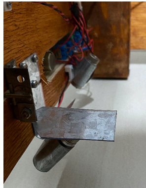
Figura 5. Os Lasers linha presos a lateral da caixa de madeira com um ângulo de aproximadamente 60° com a horizontal. Figura própria.
