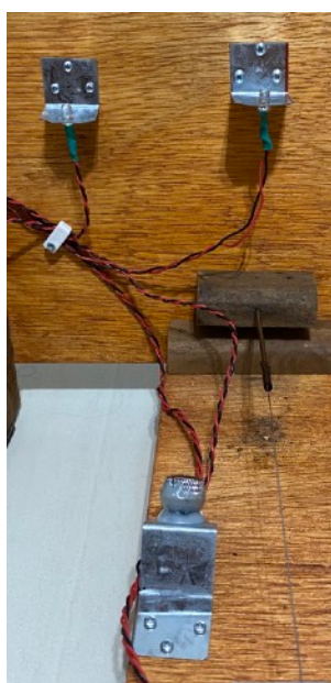
Figura A.8. O laser pontual, preso a placa de madeira central, direcionado para os LEDs que representam a estrela e sua posição aparente. Foto própria.
