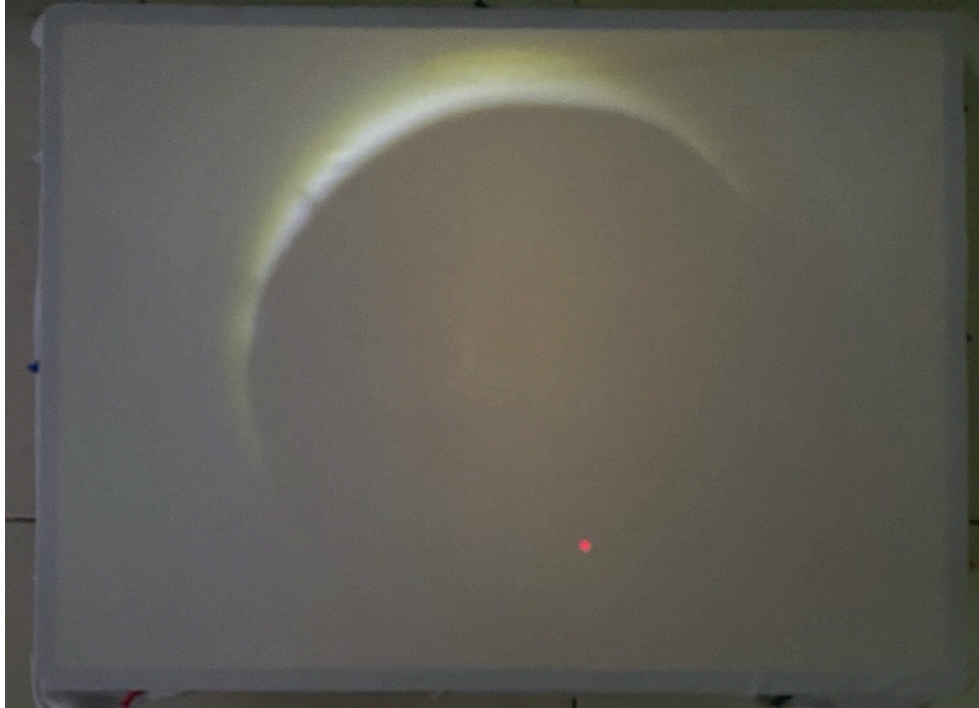
Figura B.6. Agora com o Sol (LED central) ofuscado pela Lua (Obstáculo de metal), o brilho da estrela se torna completamente visível. Figura própria
