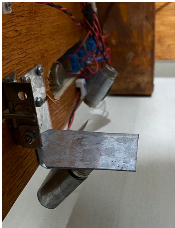
Figura A.5. Os Lasers linha presos a lateral da caixa de madeira com um ângulo de aproximadamente 60^\circ com a horizontal. Figura própria.
