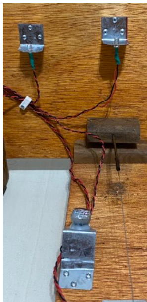
Figura 6.8. O laser pontual, preso a placa de madeira central, direcionado para os LEDs que representam a estrela e sua posição aparente. Foto própria.
