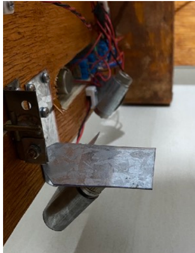
Figura 6.5. Os Lasers linha presos a lateral da caixa de madeira com um ângulo de aproximadamente 60^\circ com a horizontal. Figura própria.
