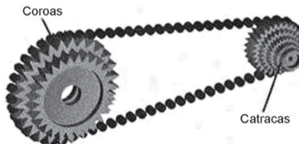
Figura Relação de 2 COROAS e 5 CATRACAS, totalizando 10 relações diferentes. (Fonte: https://descomplica.com.br/ acessado em janeiro de 2019)
