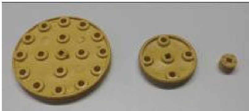
Figura Polias usadas na investigação de transmissão de movimento (Fonte: Autoria própria)
