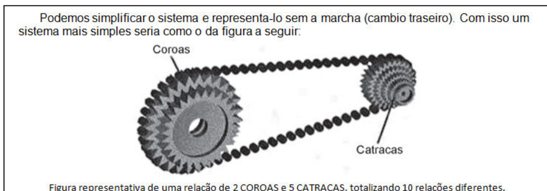
Figura 4.35 Representação das relações das marchas de uma bicicleta (Fonte: Autoria própria)
