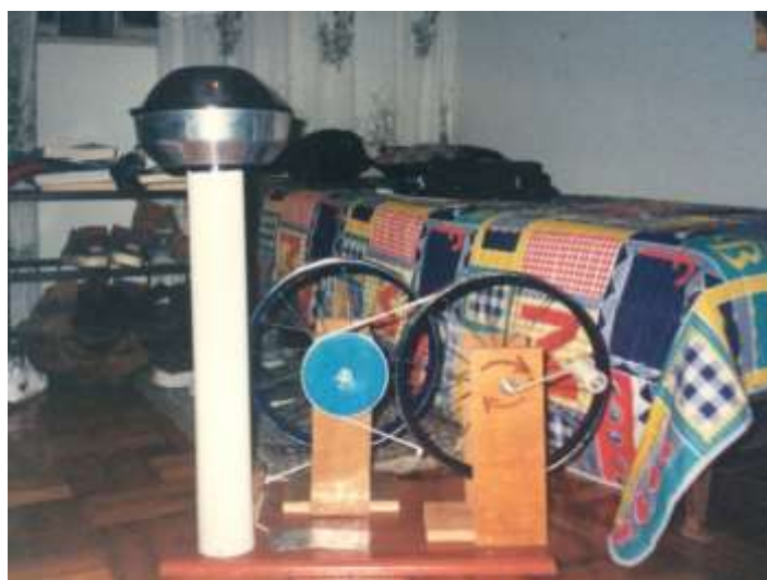
Figura 4.1 – Meu primeiro modelo de GVG, acionado por manivela. Fonte: O Autor.
