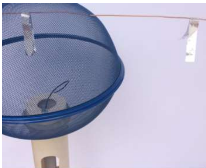
Figura 4.9 – Experimento com o GVG: Blindagem eletrostática. Fonte: O Autor.
