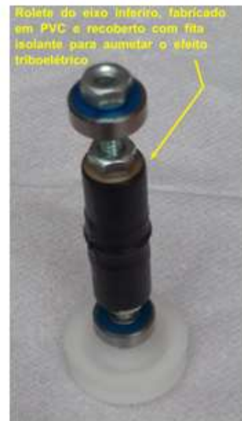
Figura 1.2 – Roletes da correia transportadora de carga. Fabricadas em plástico PVC em um torno. Fonte: O autor.
