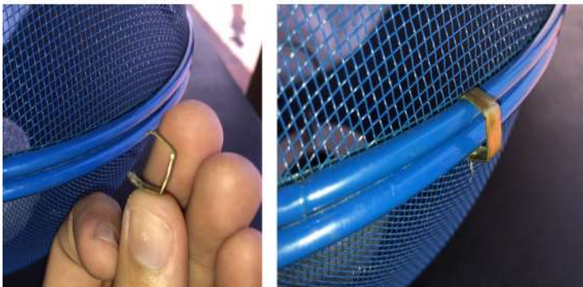
Figura 3.36 – Fixação entre as telas semiesféricas via pedaço de metal moldado em U. Fonte: O Autor.
