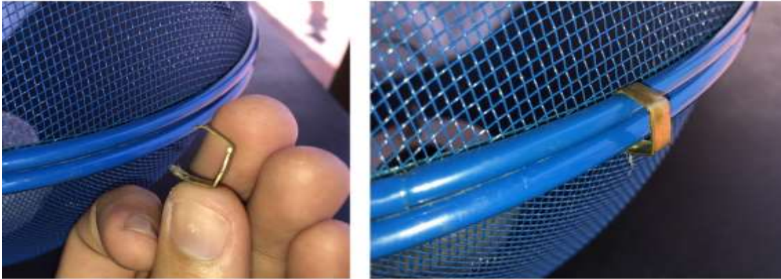
Figura 3.36 – Fixação entre as telas semiesféricas via pedaço de metal moldado em U. Fonte: O Autor.
