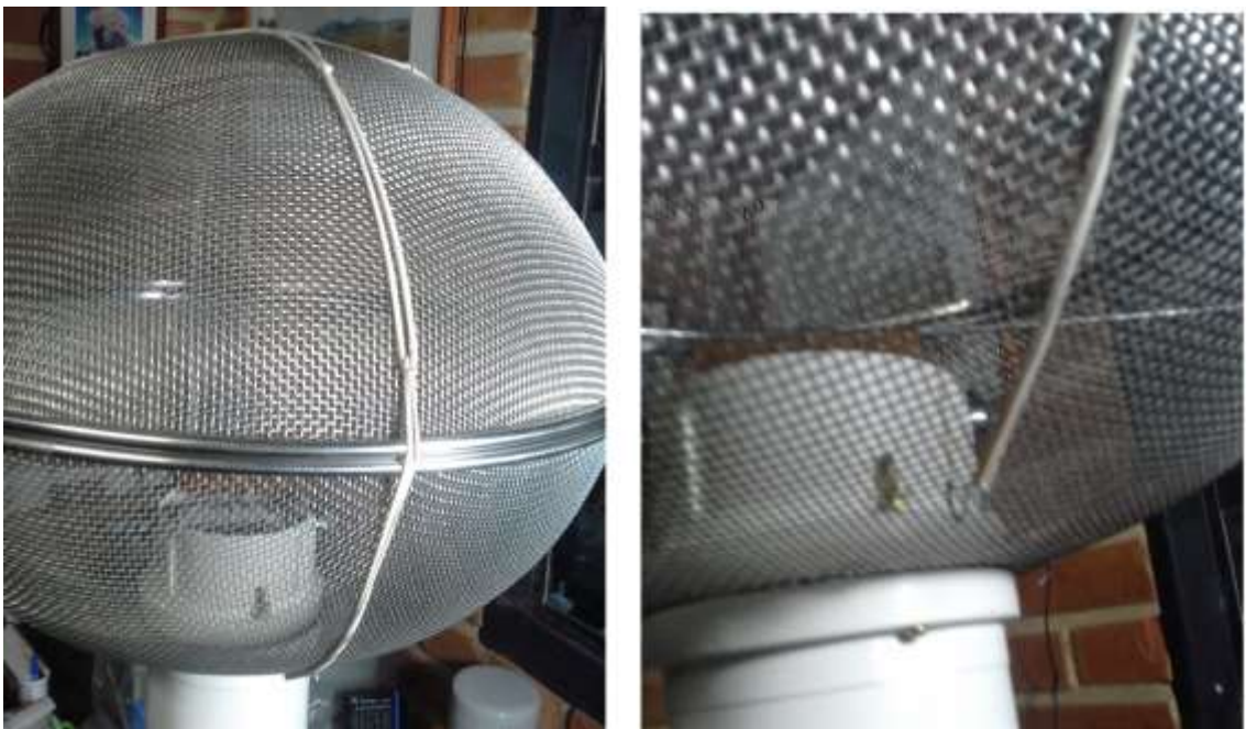
Figura 3.38 – Fixação entre as telas semiesféricas via elásticos. Fonte: O Autor.
