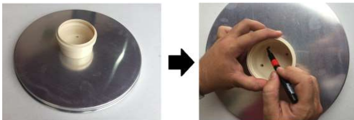
Figura 3.70 – Marcações para a execução dos furos na forma de pizza. Fonte: O Autor.
