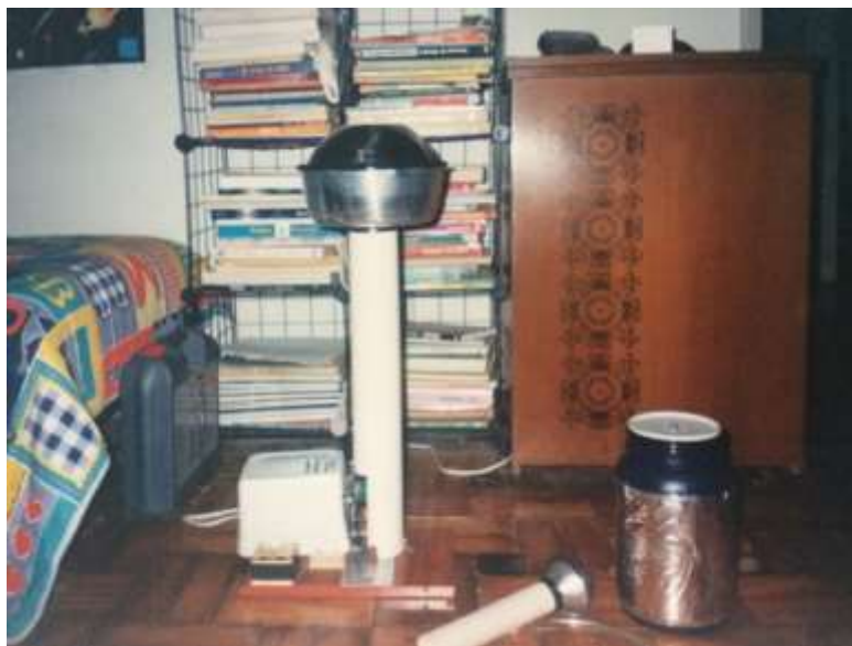
Figura 4.2 – Aperfeiçoamento do primeiro modelo de GVG, adicionando um motor. Fonte: O Autor.
