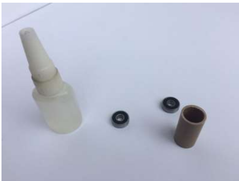
Figura 3.61 – Componentes para a construção do rolete superior do GVG. Fonte: O Autor.
