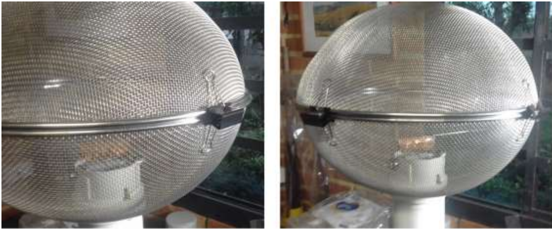
Figura 3.37 – Fixação entre as telas semiesféricas via a quatro prendedores de papel. Fonte: O Autor.
