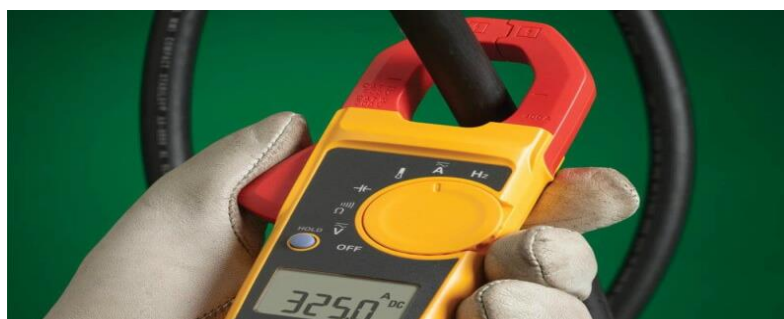
Figura 112 - Medição de corrente alternada utilizando o alicate amperímetro. Fonte: INSTRUSUL (2018).
