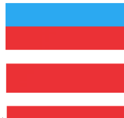
Figura 9 – Bandas de energia de um material condutor. Em vermelho está representado as bandas ocupadas e em azul desocupada da última banda de energia. Fonte: Halliday, Resnick e Walker (2009).
