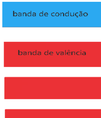
Figura 8 - Representação das bandas de energia de um material isolante; os níveis ocupados são mostrados em vermelho e os níveis desocupados em azul. Fonte: Halliday, Resnick e Walker (2009).
