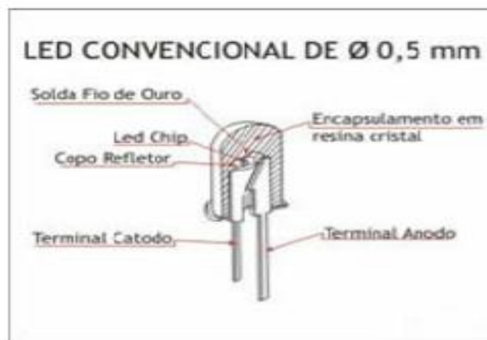
Figura 87 - Elementos constituintes do LED. Fonte: Iar Unicamp (2018).
