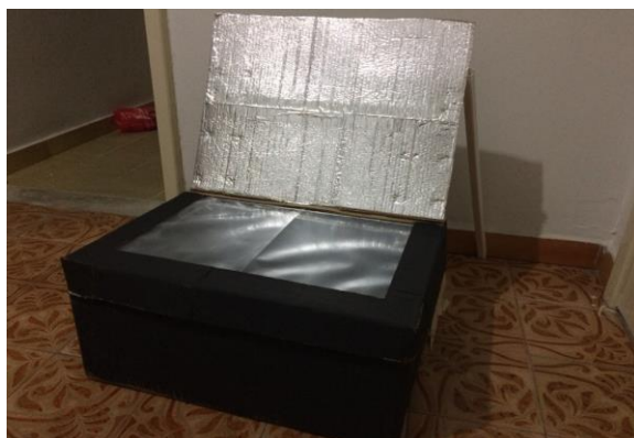
Figura 3: Forno solar de caixa Fonte: Os autores
