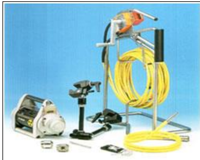
Figura 15-Equipamento utilizado em um teste de gamagrafia industrial.
