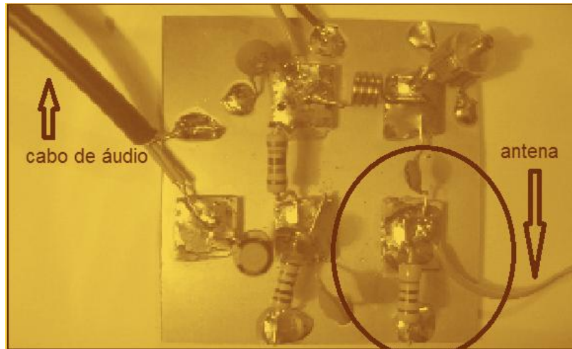
Figura 2.1.2-14 Soldagem da antena.
