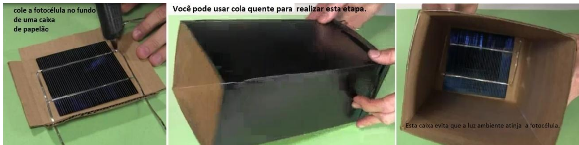
Figura 2.2.3-2 Esquema de caixa protetora fotocélula.
