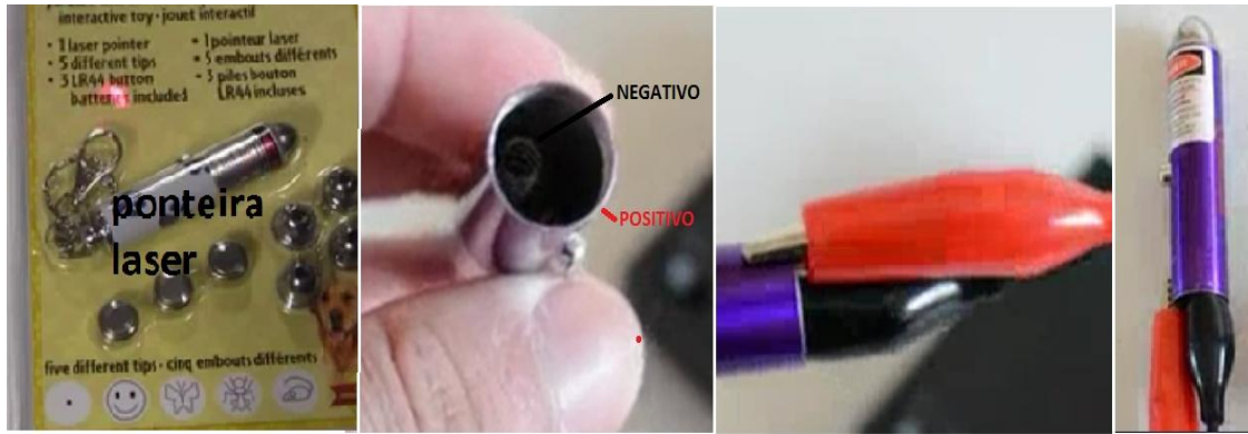
Figura 2.2.2-1 Preparação da ponteira laser.
