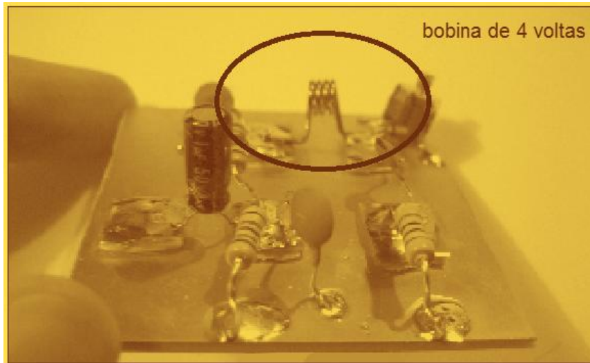
Figura 2.1.2-11 Soldagem da bobina.
