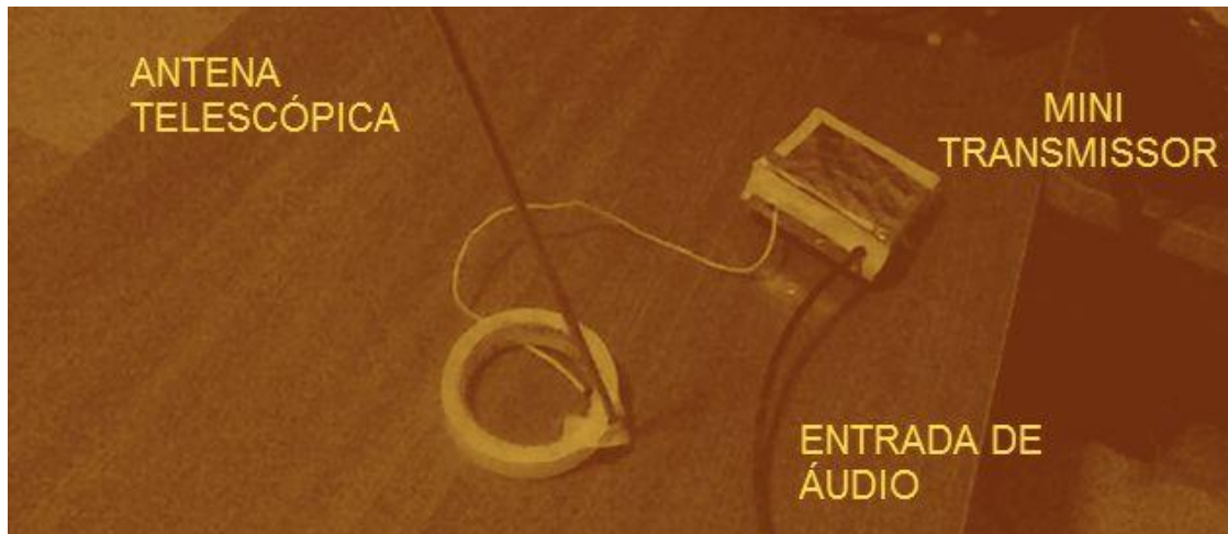
Figura 2.1.2-20 Transmissor pronto para o funcionamento.
