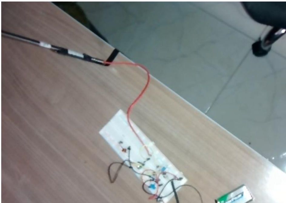
Figura 2.1.2-21 Transmissor feito no protoboard .
