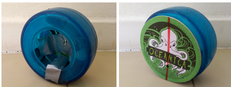
Figura 1.4: Pneu de borracha com uma massa adicional presa à sua borda interior. Do outro lado, colocamos uma superfície para esconder a massa adicional, que usamos também para marcar o centro de massa e o diâmetro que passa por ele.
