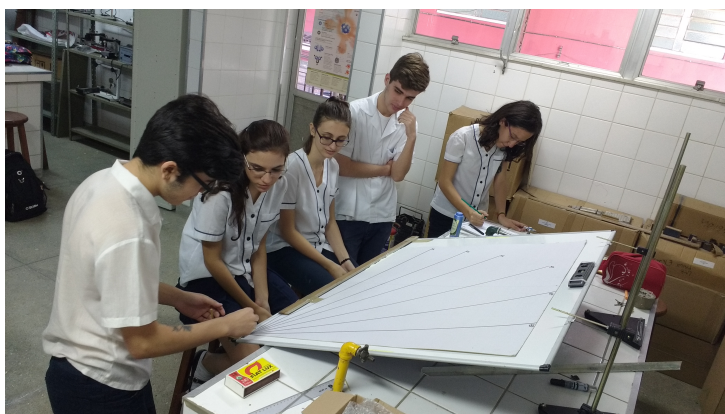
Figura 1.6: Grupo de estudantes realizando o experimento na 3ª aula. Enquanto um manuseia o lançador, outros observam para marcar o ponto de interseção com a reta inclinada (desenhada sobre a cartolina).
