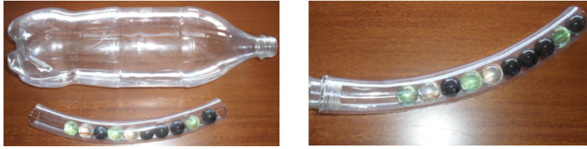
Figura 2: Material e montagem de experimento com garrada PET, mangueira e bolinhas de gude [2].
