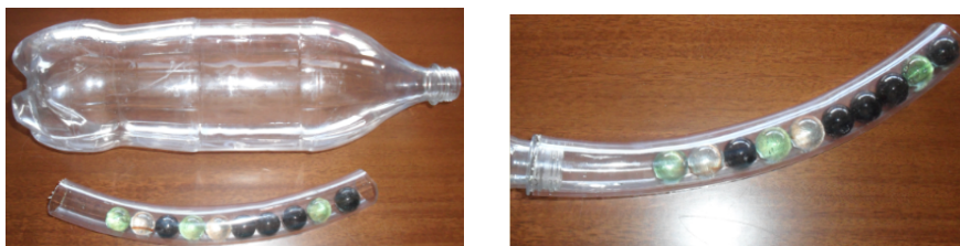
Figura 2: Material e montagem de experimento com garrafa PET, mangueira e bolinhas de gude [2].
