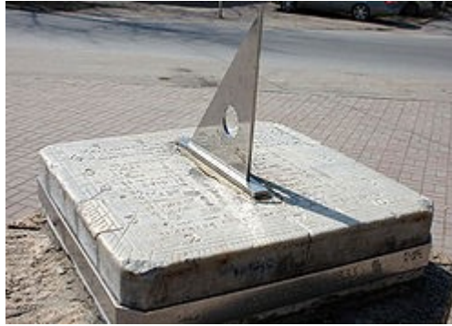
Figura 5.2.2.2 – Relógio de sol. A ponta metálica triangular é o gnômon . A hipotenusa do triângulo deve estar apontada para um dos polos celestes, ou seja, o ângulo entre a hipotenusa e o cateto da base é determinado pela latitude local [Wiki-Gnômon 2016].
