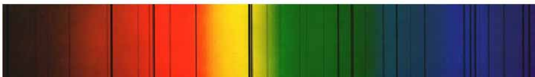
Figura A.22: Espectro contínuo com as listras escuras encontradas por Fraunhofer. 17
