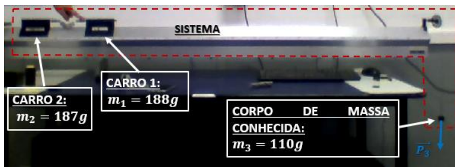
Figura 4.15: Ilustração da preparação do experimento e os seus componentes.
