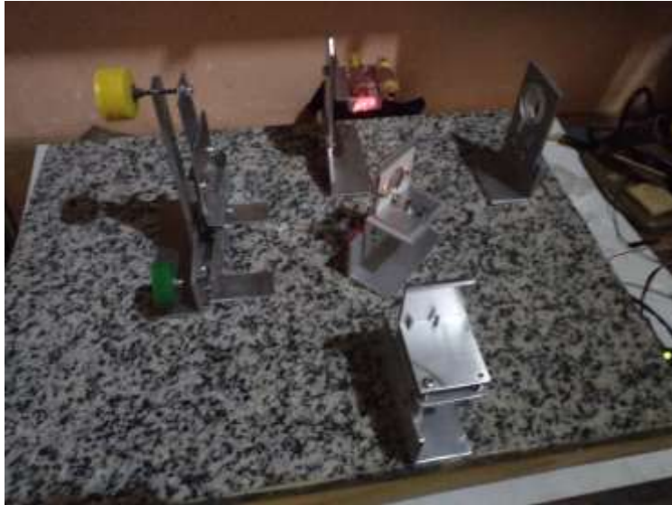
Figura 5. Interferômetro de Michelson
