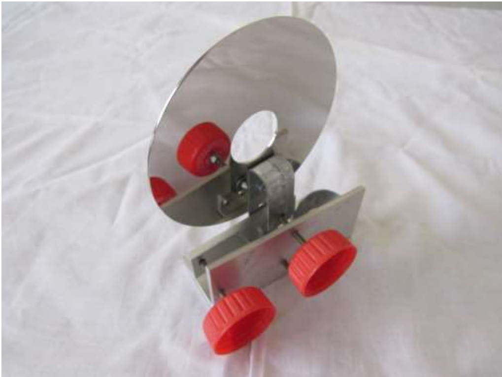
Figura 55. Suporte do espelho de Hd. Vista de trás.
