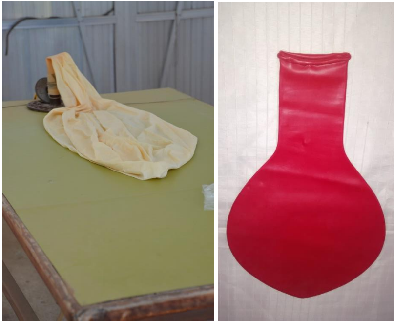
Figura 23: Balão meteorológico. À esquerda balão utilizado na Estação Meteorológica de Altitude do Galeão, à direita o balão de festas (nº350), utilizado neste projeto.
