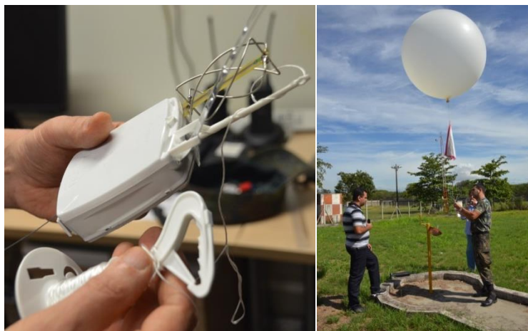
Figura 1: Radiossonda RS92-SGP utilizada na EMA-GL (Estação Meteorológica de Altitude do Galeão).
