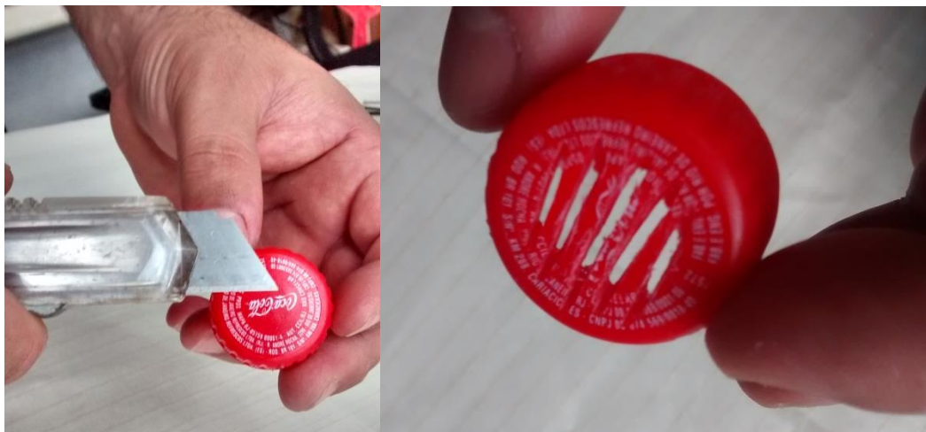
Figura 10: Construindo um abrigo contra radiação solar para o sensor BMP180.
