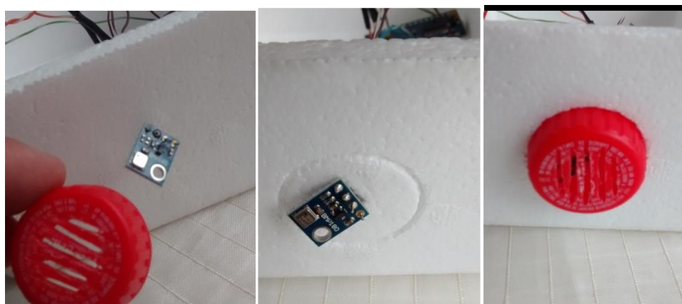
Figura 11: Marcação da posição do abrigo do sensor BMP180.
