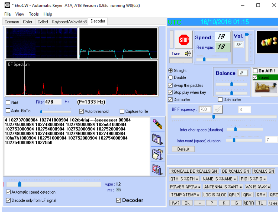
Figura 21: EhoCW decodificando os dados da radiossonda
