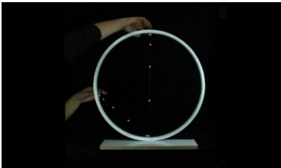
Figura 8: Superposição de cinco instantes do movimento de queda de duas partículas.
