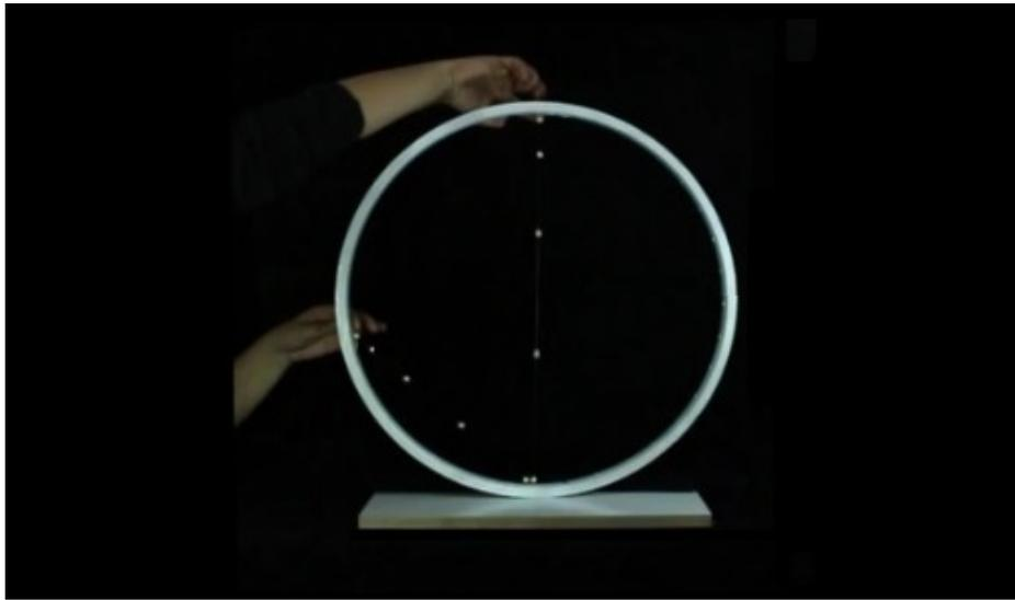
Figura A.8: Superposição de cinco instantes do movimento de queda de duas partículas.
