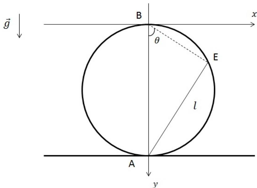
Figura A.1: Partículas podem deslizar livremente ao longo das cordas BA e EA.
