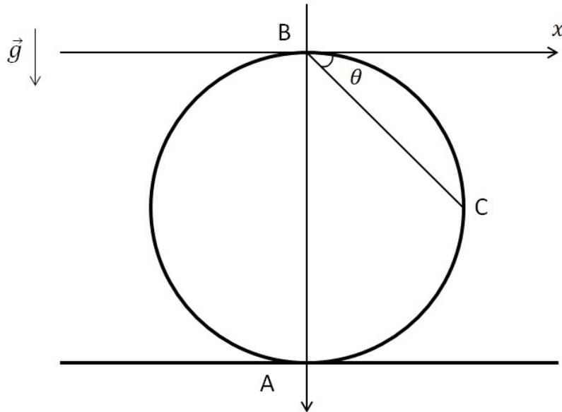
Figura 4.2: Consideraremos um corpo deslizando livremente pela corda  $BC$ .
