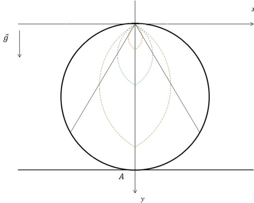
Figura 5.2: Novo lugar geométrico das posições instantâneas dos corpos. As linhas pretas à direita e à esquerda do diâmetro representam o caminho percorrido pelo centro das circunferências durante a descida dos corpos.
