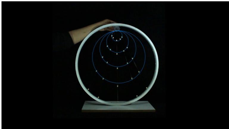
Figura 4.6: Corpos deslizando em uma configuração circular ao longo de fios inscritos em uma circunferência.
