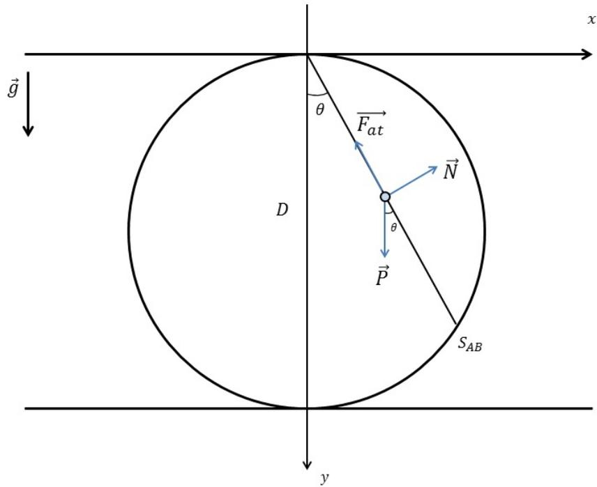
Figura 5.1: Corpo deslizando por um plano inclinado.
