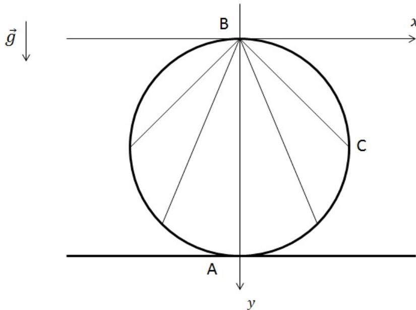
Figura 4.1: Diferentes corpos podem deslizar livremente ao longo dos planos inclinados inscritos na circunferência
