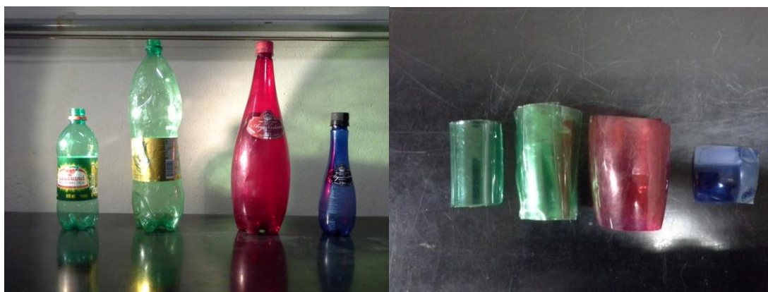
Fig 2.12 – À esquerda: Garrafas utilizadas para a confecção dos filtros de PET. À direita: Garrafas PET já cortadas para servirem de filtros.
