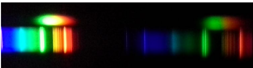
Fig. 2.8 – Imagem obtida a partir de uma foto, tirada com uma câmera de celular de 3MP, pela rede difração de CD no espectrômetro de baixo custo, do LED verde sobreposto à lâmpada fluorescente. À esquerda podemos ver a 1º ordem de difração, o espectro do LED na 1º ordem de difração é muito difuso. A direita a 2º ordem de difração, o espectro do LED na 2º ordem de difração é mais nítido. Podemos observar que a 2º ordem de difração é bem mais espaçada.
