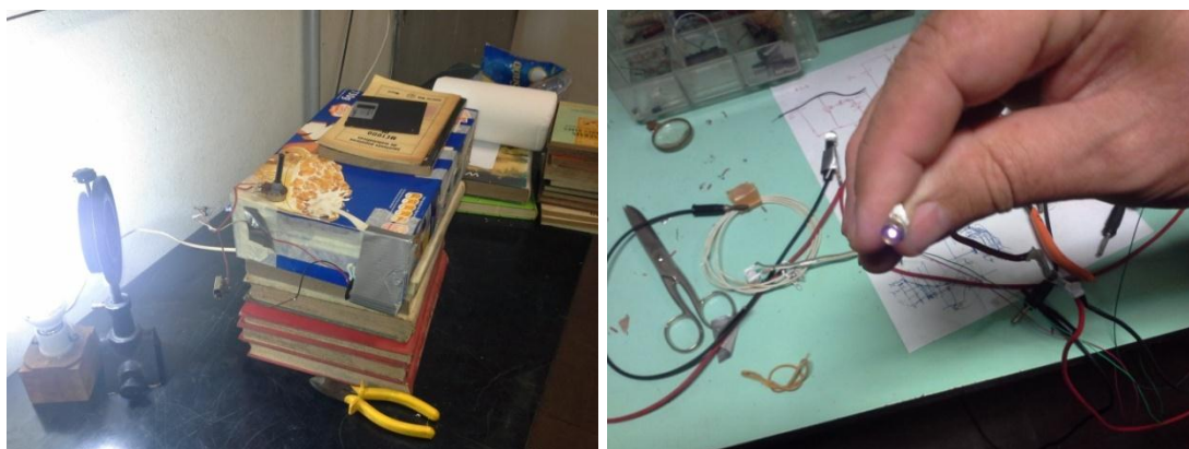
Fig. 2.6 – À esquerda os apoios com livros para o espectrometro de baixo custo. À direita foto do LED infravermelho aceso, sem a camera não dá para perceber se o LED está ou não aceso.
