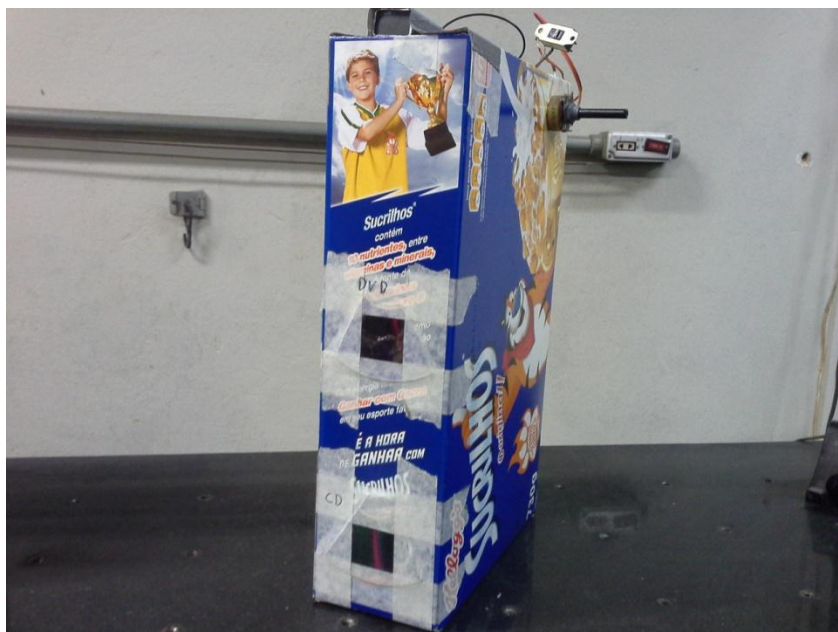
Fig. B.6 – Do lado oposto à fenda fizemos dois furos retangulares, um no meio da caixa e outro na parte de baixo. No furo retangular do meio foi fixado o DVD. No furo abaixo foi posto o CD (para fazer a fixação foi utilizada fita crepe). O CD e o DVD foram cortados e retirados à película metálica.
