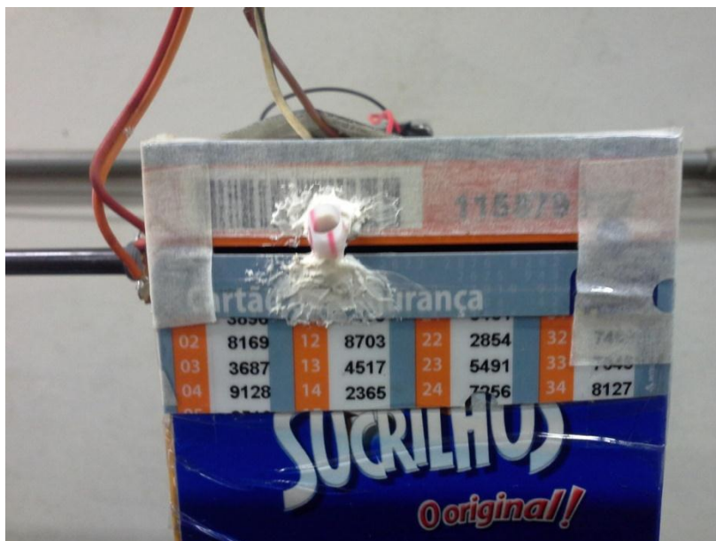
Fig. B.3 – Na parte lateral de cima da caixa foi feita uma fenda e para melhor delinear-la utilizamos um cartão plástico. Neste cartão foi feito um furo de mesmo diâmetro do canudo para poder fixá-lo (a fixação foi feita com cola branca). O canudo servirá como sustentação do LED para ser observado seu espectro em conjunto com a da lâmpada fluorescente.
