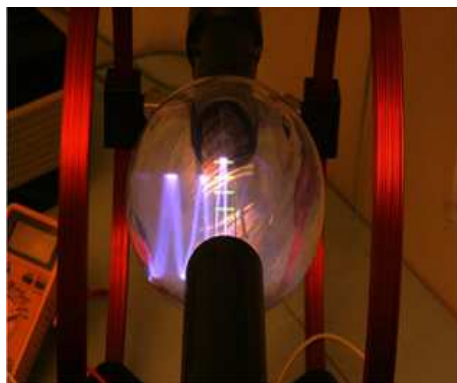
Figura 5: Feixe de elétrons. (Mendes da Silva et alii ). O feixe forma uma hélice pela modificação do ângulo.
