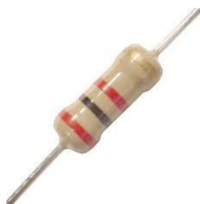
Figura 1.7 – Um típico de resistor de carvão usado em aplicações de eletrônica. As barras coloridas servem para indicar o valor da resistência através de uma convenção apresentada no Anexo II.
