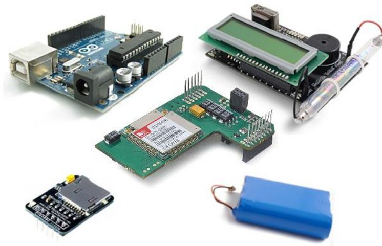
Figura 16 – Componentes do projeto: Arduino UNO, Kit Geiger, MicroSD, GPS e Bateria.
