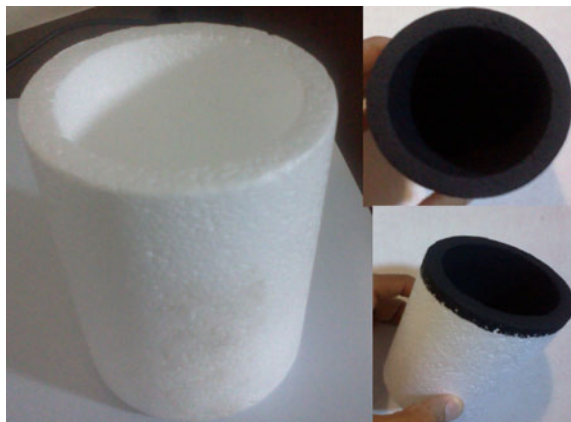
Figura 3.4: Preparação de nosso recipiente que originalmente era usado para manter a temperatura de latas de cerveja e refrigerantes.
