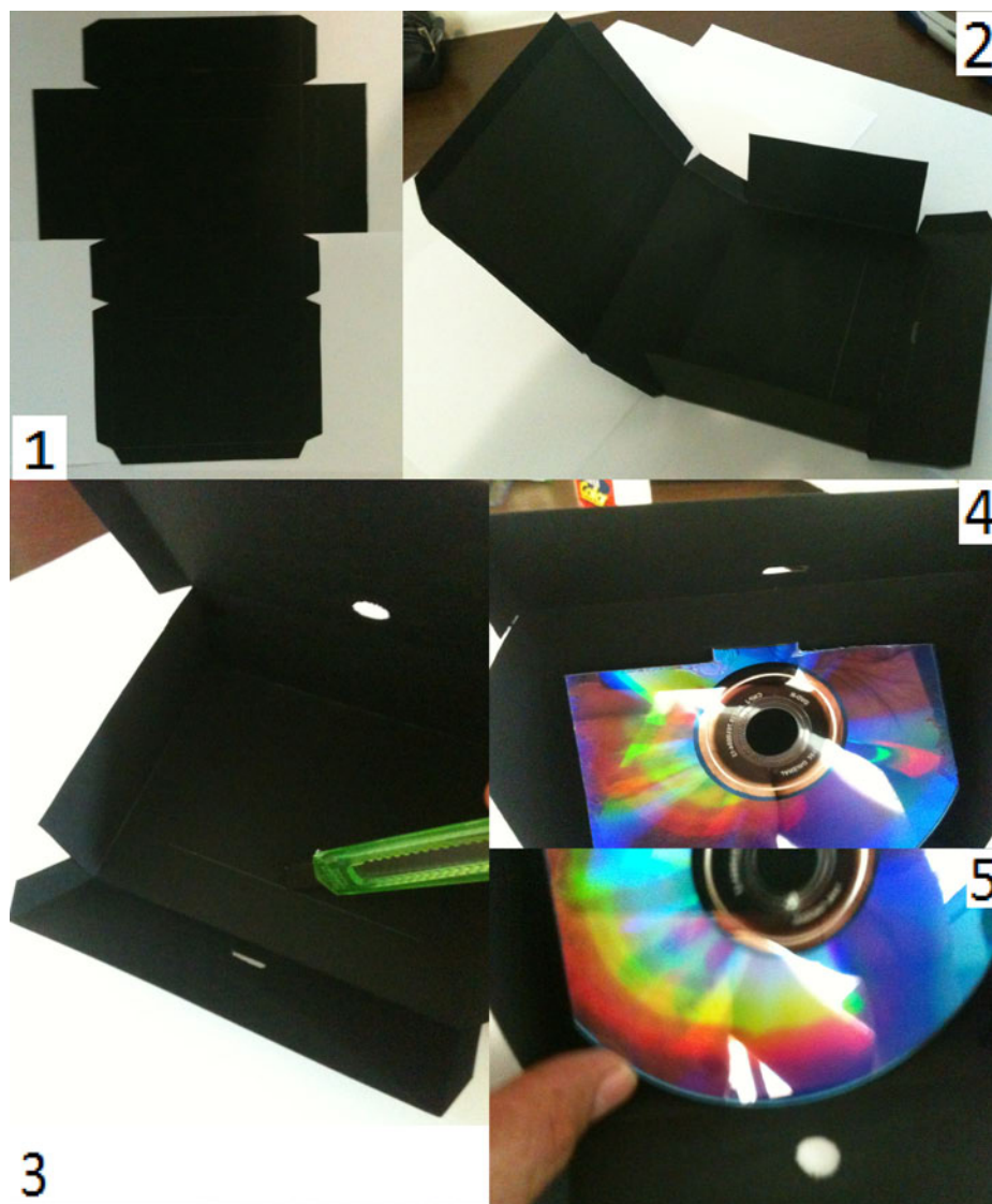
Figura B.2: 1. Recorte do papel cartão; 2. Dobradura das regiões pontilhadas; 3. Abertura dos orifícios e da fenda para encaixe do DVD; 4. Encaixe do DVD na fenda; 5. Ajuste do DVD.
