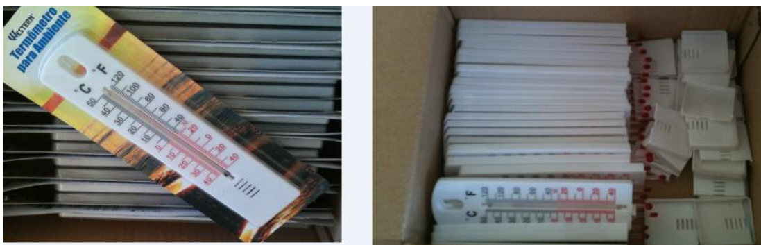
Figura 4.1 - Termômetros inteiros e com a base inferior cortada deixando o bulbo exposto
