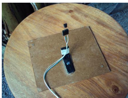
Figura 4.12 - Sensor de temperatura fixado em um pedestal de plástico no centro da maquete.
