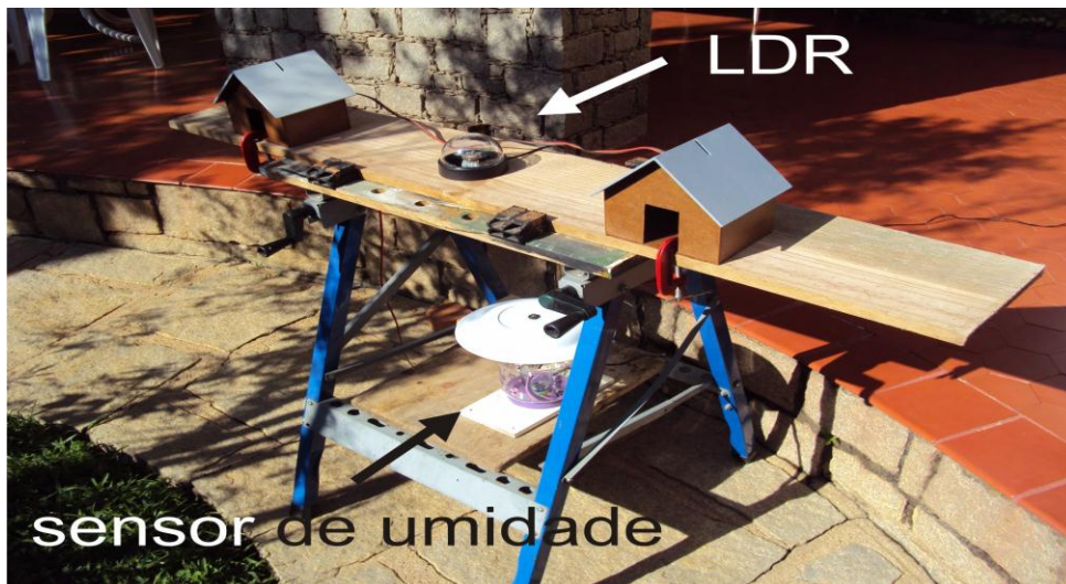
Figura 4.16 – Montagem experimental de testes para o estudo da proposta “Pinte o seu Telhado de Branco”. Na foto vemos as duas maquetes usadas, uma com o telhado pintado de branco e outra pintada de cinza. Entre as duas maquetes está o resistor LDR.
