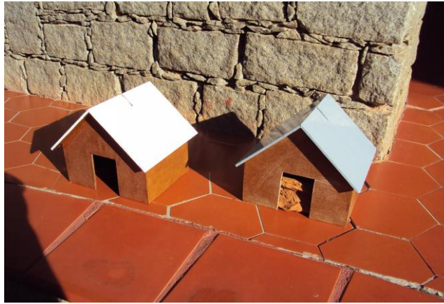
Figura 4.11 – Maquetes em madeira MFP com telhados branco e cinza
