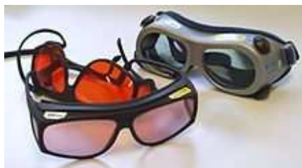
Fig. B.2 - Óculos de proteção para operação de lasers.
