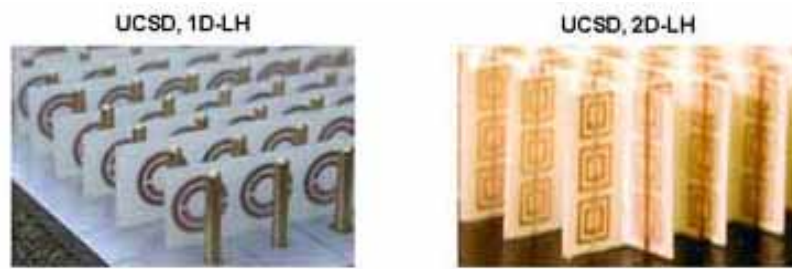
Figura 7.6: Metamateriais construídos com fios metálicos para produzir a resposta elétrica e SRRs para o efeito magnético. Adaptado de [Pendry 2006].
