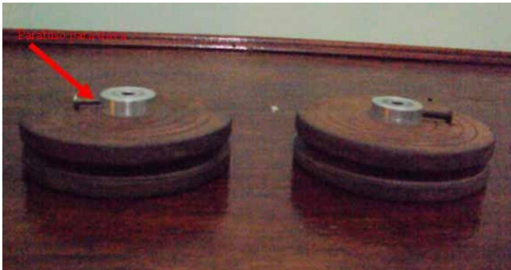
*Figura A.8 – Vista lateral das 2 polias maiores com 10 cm de diâmetro , 2 cm de espessura e com orifício no centro de 7 mm de diâmetro cada.*
