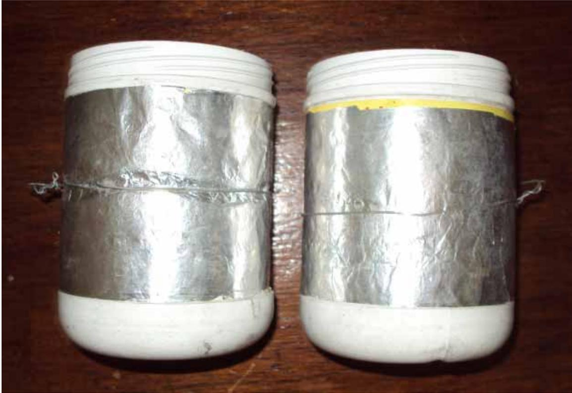
*Figura A.77 – Folha de papel alumínio da parte externa da garrafa de Leyden envolvida por arame.*
