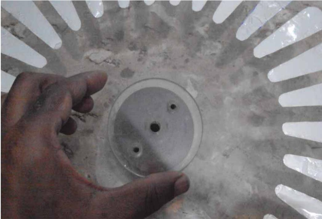
*Figura A.34 – Alinhando os furos do disco de acrílico menor, com os furos do disco de acrílico maior e também com os furos da polia.*
