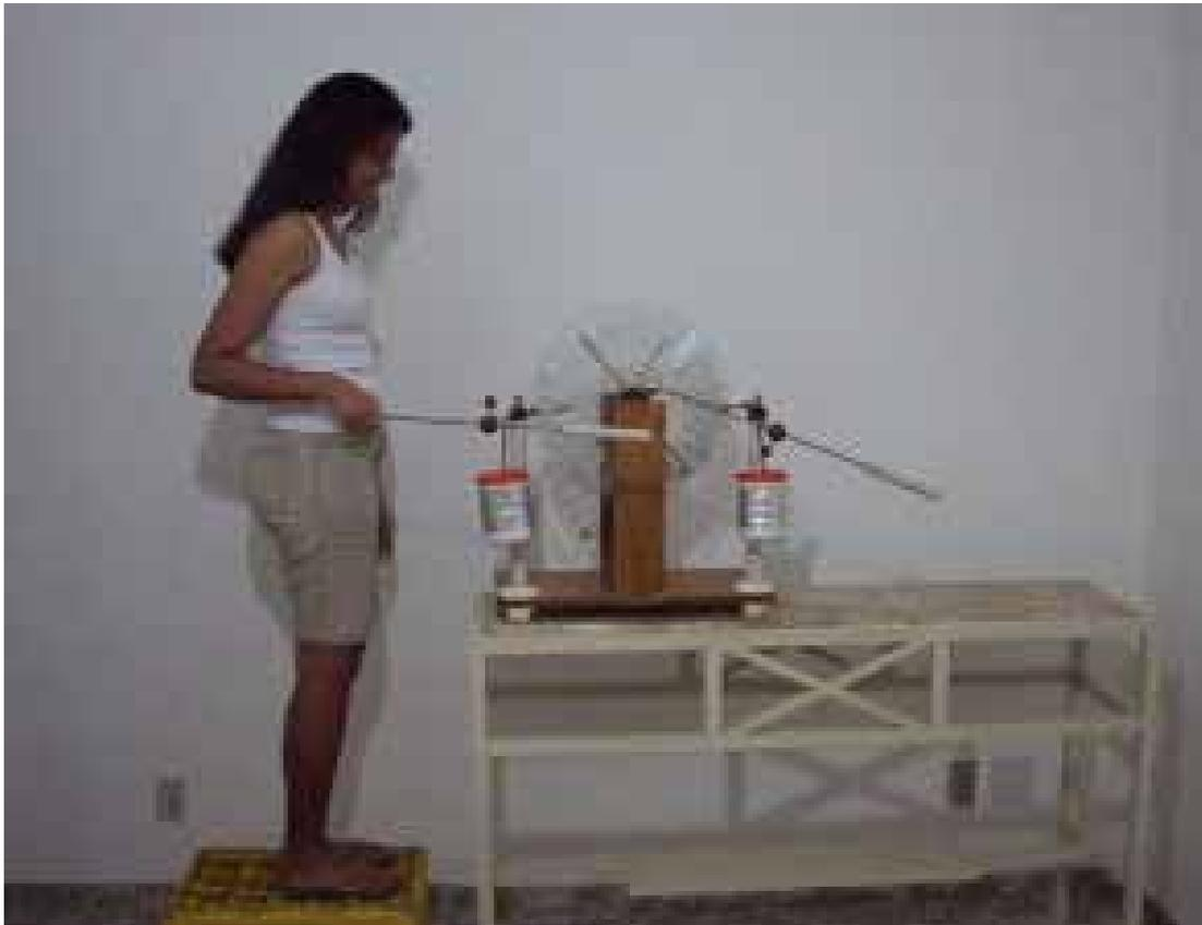
*Figura 3.1 – Estudante em cima da caixa de refrigerante e em contato com um dos terminais da máquina descarregada.*
