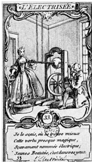
*Figura 1.1 – Típica máquina de fricção utilizando um bulbo de vidro (Sec. XVIII).*
