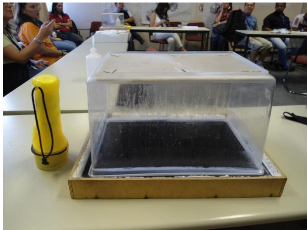
Aparato experimental utilizado na “Sessão Experimental com Câmara de Nuvens”
