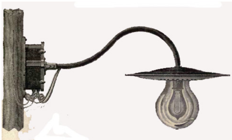
Figura: Lâmpada elétrica em poste de iluminação pública.
