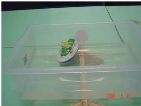
Figura 1 - A cuba está em equilíbrio com a lancha próxima ao eixo de apoio.
