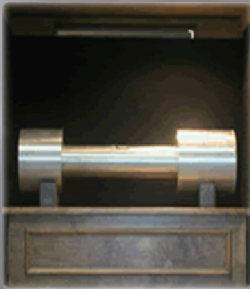
Consiste de um pedaço de metal sólido equipado com detectores eletrônicos de vibrações.
