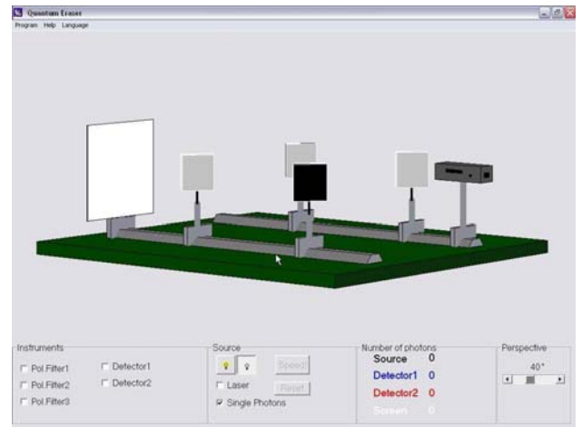
Figura 1 - Interferômetro de Mach-Zehnder [15]. Na perspectiva de 40^\circ mostrada, vê-se a fonte à direita no trilho interno e o anteparo à esquerda no trilho externo. Há dois espelhos semi-refletores: o mais próximo à fonte no trilho interno e o mais próximo ao anteparo no trilho externo. Os outros dois espelhos são totalmente refletores.
